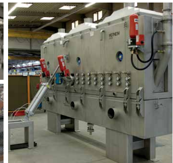
Wirbelschicht-Agglomerator mit Explosionsunterdrückungs-System.
