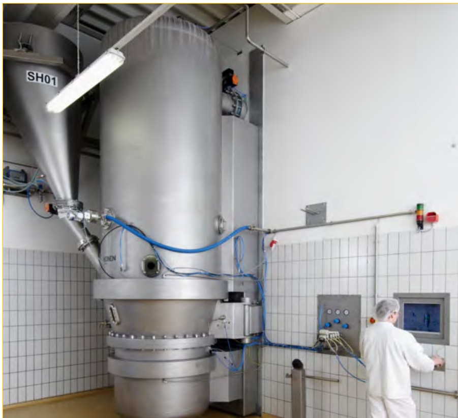
Batch-Anlage mit Top- bzw. Bottom-spray Einrichtung
