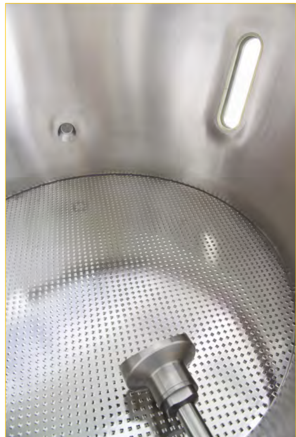
Anströmboden in einer Batch-Anlage
