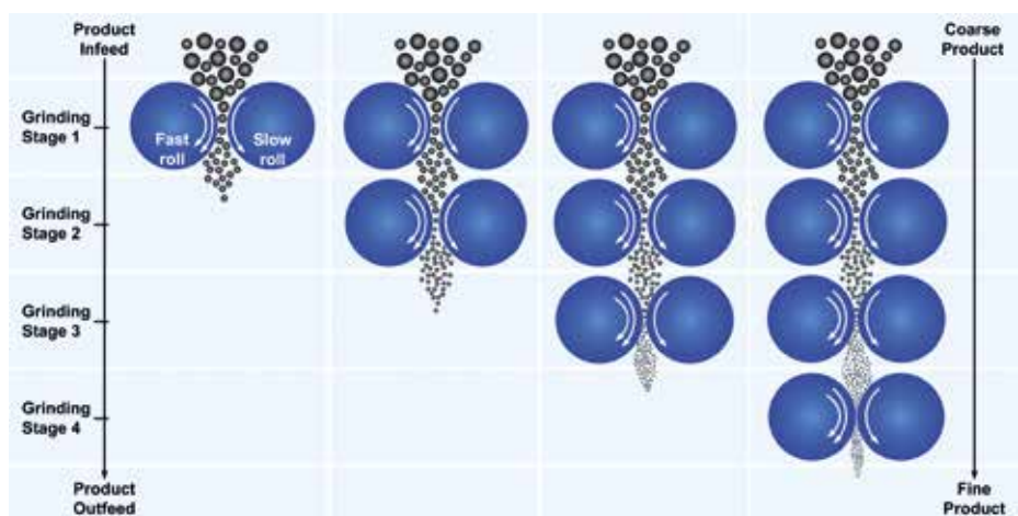
Das Prinzip der mehrstufigen Zerkleinerung mit Neuhaus Neotec Walzenmahlwerken
