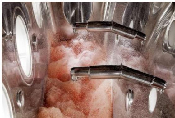
*In der Wirbelschicht herrschen optimale Bedingungen für einen effektiven Stoff- und Wärmeaustausch.*
