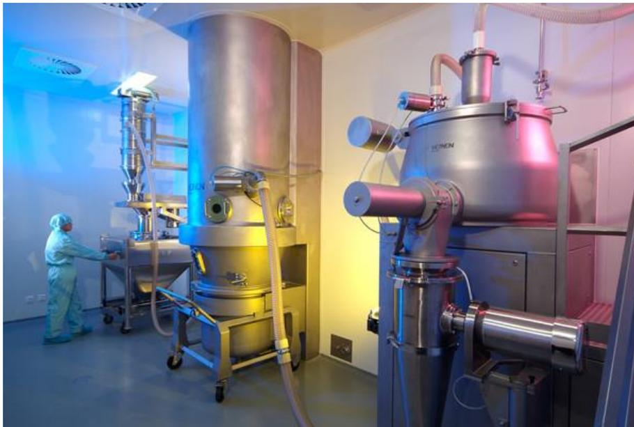
*Die chargenweise Verarbeitung in einer Batch FB-Anlage ist besonders bei häufigen Produktwechseln effektiv.*
