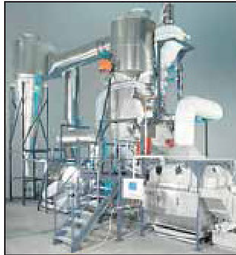
Der RG-150-Röster kann 1500 Kilo Kaffee pro Stunde verarbeiten. Foto: ch
