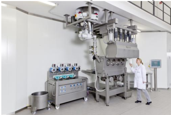
Oben: Unsere moderne Wirbelschichtanlage im neuen Technikum.
